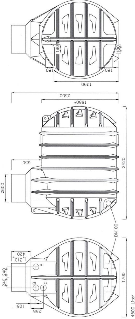
Regenwassernutzung: A Anschluss Zulauf DN 100; B Anschluss Versorgungsleitung DN 100; C Anschluss Überlauf DN100
