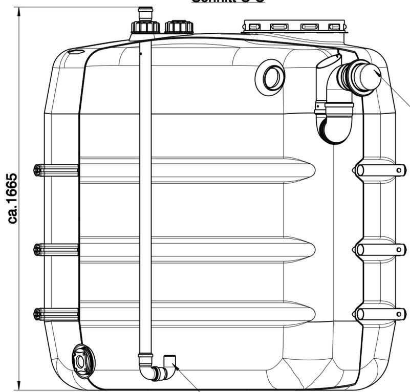
Überlaufsiphon DN 110 mit Kleintiersperre (Montage links oder rechts am Behälter möglich)
