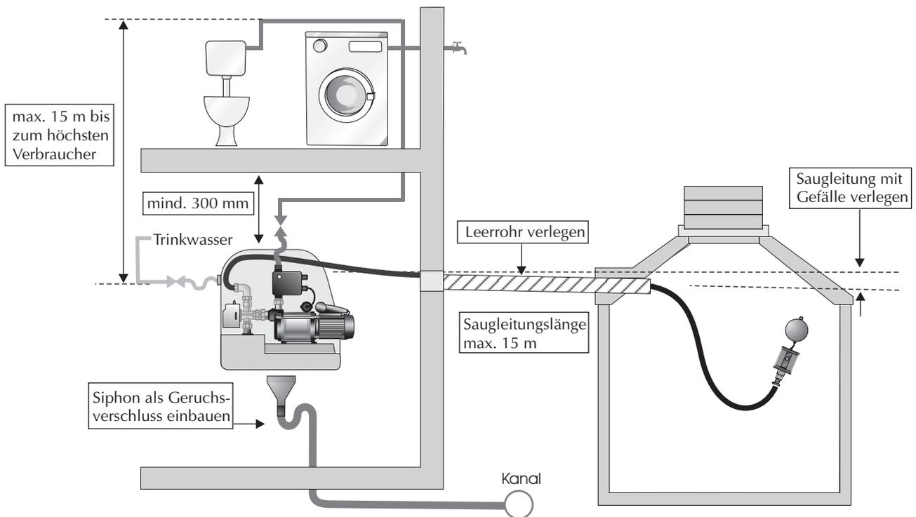
Bild 9 Hydraulischer Anschluss der Blue Box 15/4
