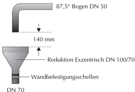
Bild 3 Freier Auslauf gemäß DIN 1989
