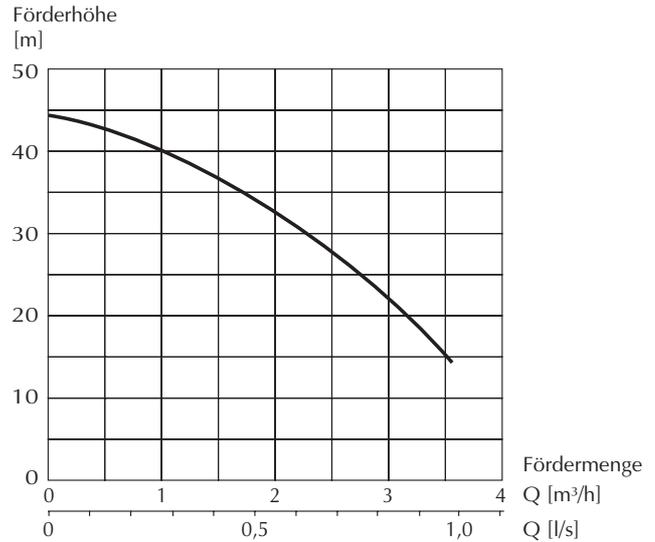
Bild 5 Pumpenkennlinie:
