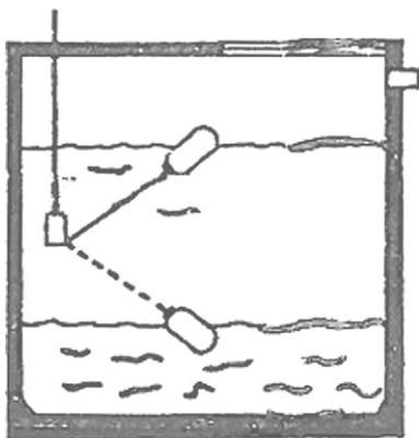
Bild 10 Montage des Schwimmerschalters
